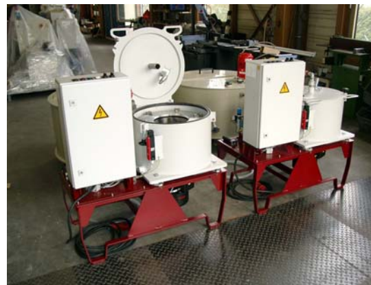
U-15 Zentrifugen-Anlage mit Abwasserbehälter
