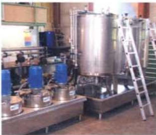
Aufbereitungsanlage mit Zentrifugalseparatoren vom Typ S-15
